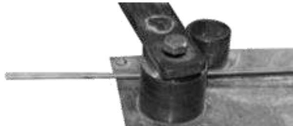
Step 5: Place a 3mm S. S. rod on the jig.
