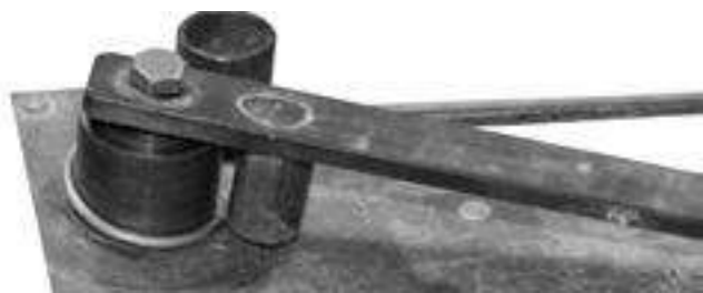
Step 6: Bend of the S. S. rod for making hook.
